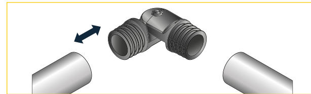
10 - Legen Sie den Handlauf auf die Pfosten
