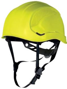
Casco de obra ABS. Estilo casco de montaña : sin visera para una mejor visión vertical. Muy poco estorbo. Ligero. Arnés interior de poliámidas: 3 bandas textiles con 8 puntos de fijación. Sudadera termoformada. Sistema de ajuste ROTOR : desde los 53 a los 63 cm de contorno de la cabeza. Vendido con un barbuquejo 3 puntos de fijación. Especialmente diseñado para trabajos en altura. Aislamiento eléctrico hasta 1000 VAC o 1500 VCC.
