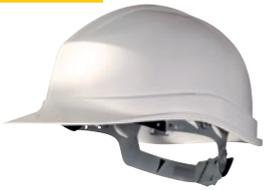
Casco de obra de polipropileno (PP) o de polietileno de alta densidad (HDPE), con tratamiento ultravioleta. Arnés interior polietileno (LDPE) con 8 puntos de fijación. Sudadera esponja. Ajuste guía corredera : desde los 53 a los 63 cm de circunferencia de la cabeza. Resistencia eléctrica hasta 1000 VAC o 1500 VCC. Adaptador universal para accesorios. Fijación para barbuquejos 2 ó 4 puntos.
