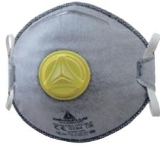
Caja de 10 mascarillas filtrantes FFP2 de fibra sintética no tejida impregnada de carbón activo. Protección contra los olores dañinos (por ej. humos de soldadura). Forma convexa. Lámina nasal de ajuste. Refuerzo borde espuma bajo lámina nasal. Válvula de exhalación de altas prestaciones. Test opcional DOLOMITE para un confort respiratorio prolongado.
