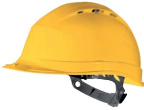
Casco de obra ventilado de polipropileno (PP) de alta densidad, con tratamiento ultravioleta. Arnés interior polietileno con 8 puntos de fijación. Sudadera de esponja. Ajuste guía corredera : desde los 53 a los 63 cm de circunferencia de la cabeza. 2 posicionamientos posibles del contorno de la cabeza (alto / bajo) para una mejor comodidad. Casco ventilado con ventilación regulable.
